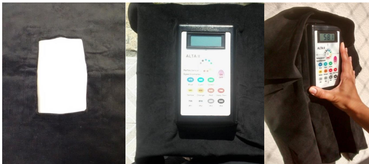
Figura 6 – Proteção da base (tecido escuro) utilizada em medições com o ALTA II.
