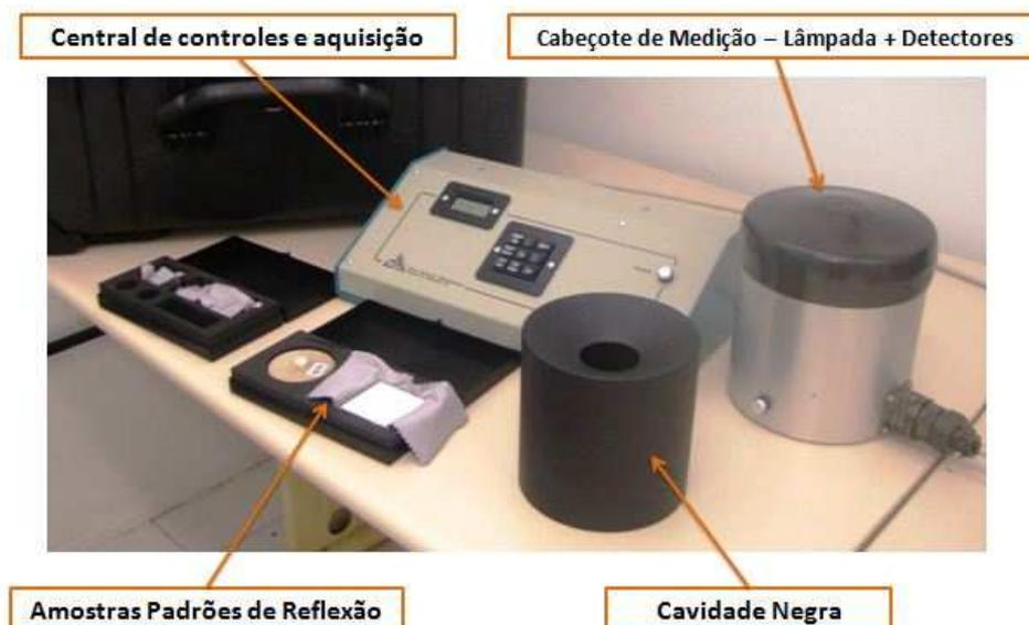
Figura 4. Componentes do refletômetro solar.
