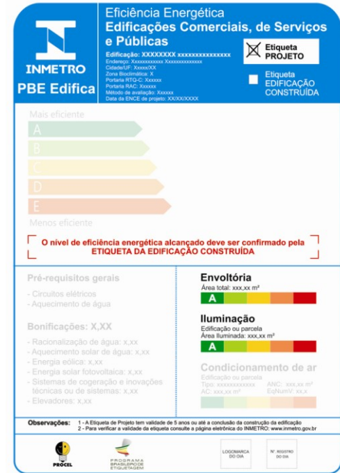
ENCE parcial para edificações onde apenas a envoltória e o sistema de iluminação foram inspecionados
