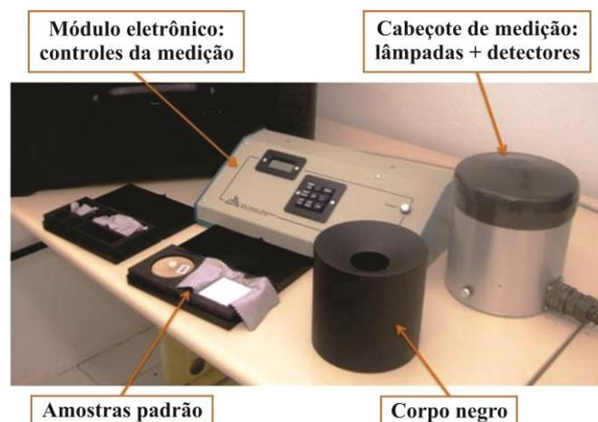
Figura 5 – Refletômetro solar. (Fonte: MARINOSKI et al., 2013)
