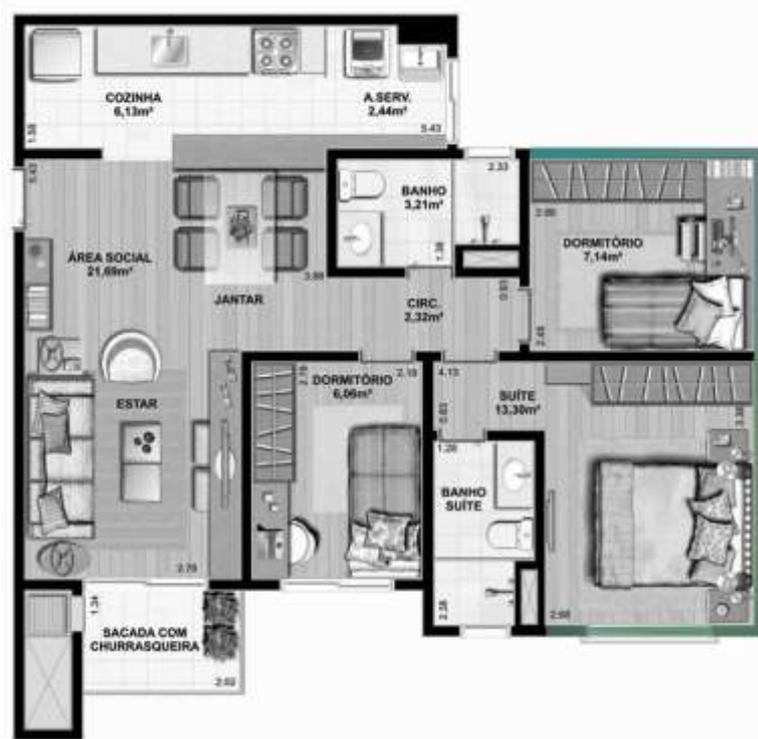
**Figura 28- Exemplo de UH de “esquina”: Paredes em contato com o exterior com mais de quatro metros de comprimento, para cada cômodo, destacadas em verde**
