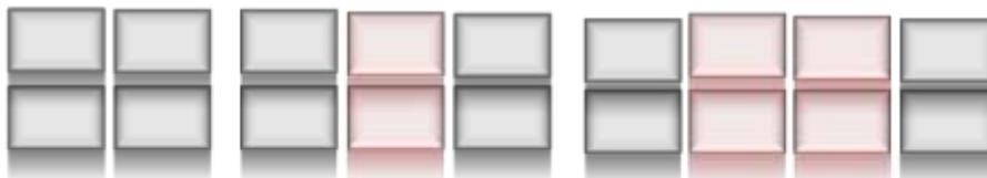
Figura 18- Ilustração de formas pavimentos tipo. Destaque em vermelho para as UHs sem ventilação cruzada
