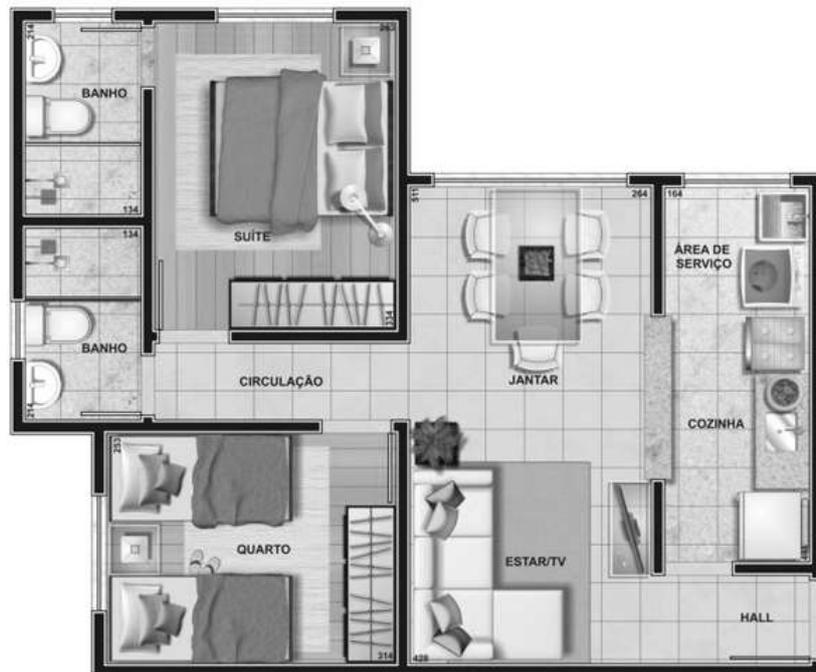
**Figura 38 Exemplo de UH com parede do estar/jantar em contato com o exterior em apenas uma orientação**
