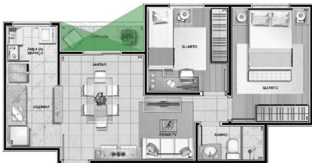
Figura 43- Exemplo de sombreamento pelo recuo da parede do estar/jantar
